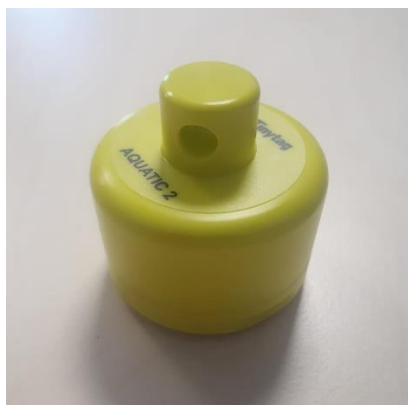
Figure 12 : Sonde thermique Tinytag, Luc TISSOT, 2020
